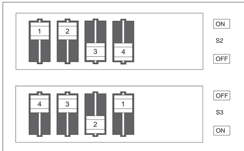
Bild 4-6 Standardeinstellung der Schalter S2 (1..4) und S3 (1..4) für 333 MHz Pentium PII CPU
