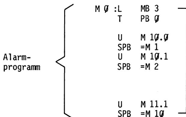
Das Merkerbyte MB 3 wird direkt ins Peripheriebyte PB 0, d. h. direkt zu den Ausgängen transferiert. Das Prozeßabbild der Ausgänge wird mit erneuert. Durch Abfrage der Merker M 10.0...M 11.1 (es ist nur ein Merker eingesetzt) wird das Anwenderprogramm an der zuletzt festgelegten Rücksprungstelle fortgesetzt.
